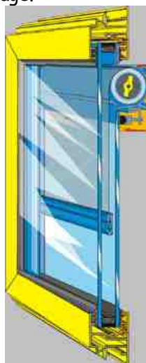
Stores intégrés au double vitrage (Agero - coupe de principe)
